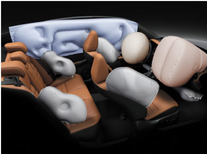
Hệ thống túi khí SRS IS được trang bị túi khí SRS hai giai đoạn (hàng ghế trước), túi khí đầu gối SRS (hàng ghế trước), túi khí bên hông SRS (hàng ghế trước và sau) và túi khí rèm SRS (trên rèm cửa sổ trước và sau). *1
