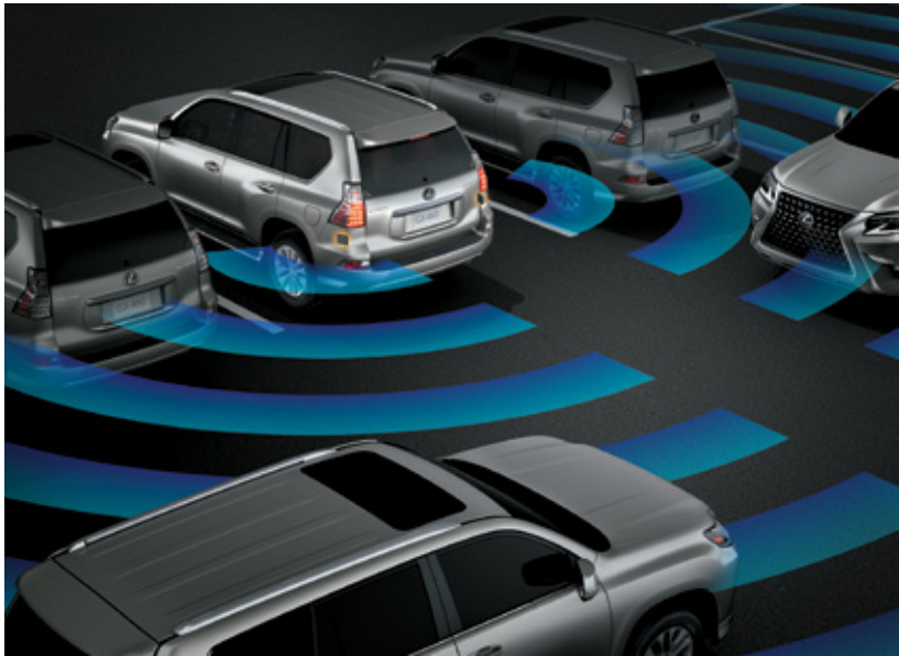
Hệ thống phanh an toàn khi đỗ xe PKSB Hệ thống phát hiện chướng ngại vật xung quanh xe hoặc phương tiện đang tiếp cận từ phía sau và tự động kích hoạt hệ thống phanh.
