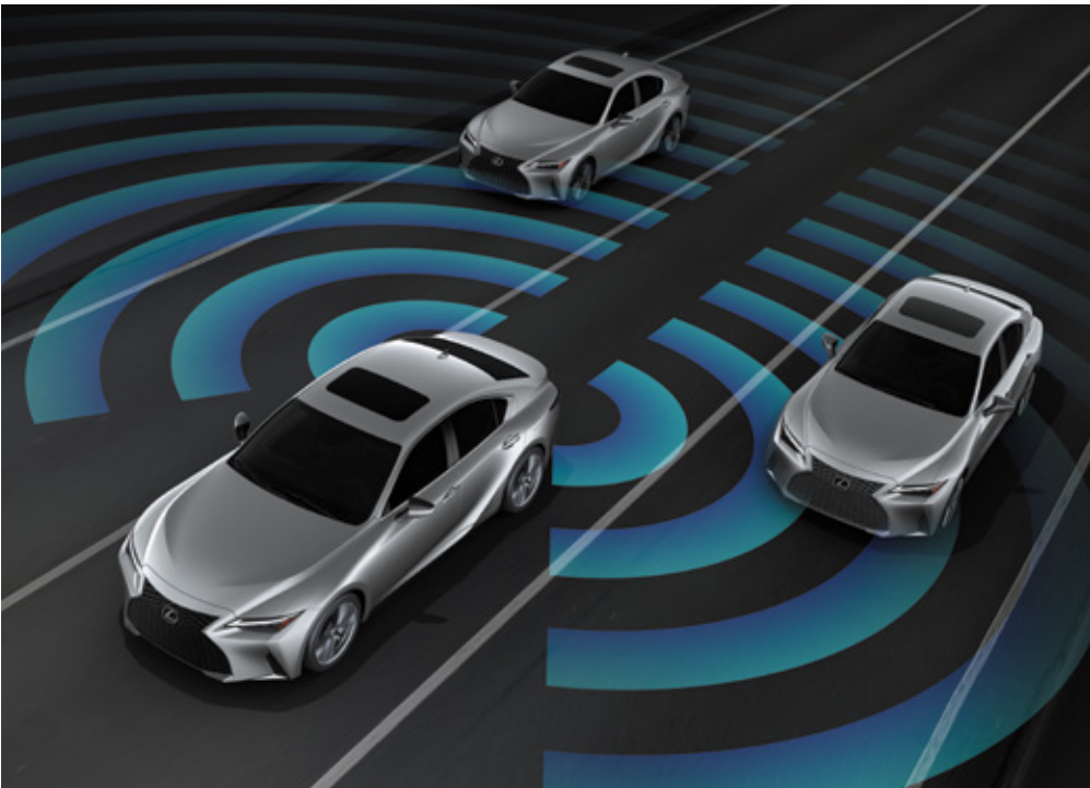
Hệ thống cảnh báo điểm mù BSM Khi các ra-đa bước sóng milimet đặt ở căn sau phát hiện có xe chạy trên làn đường bên cạnh mà người lái không thể nhìn thấy trên gương chiếu hậu, hệ thống sẽ kích hoạt đèn cảnh báo trên gương chiếu hậu ở bên tương ứng ngay khi xe tiến vào điểm mù này.
