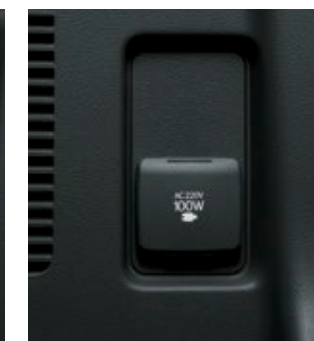
Ổ cắm điện (Khoang hành lý)
