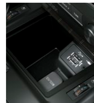
Cổng USB / Giắc cắm mini / Ổ cắm điện (Hộp đựng đồ trung tâm)
