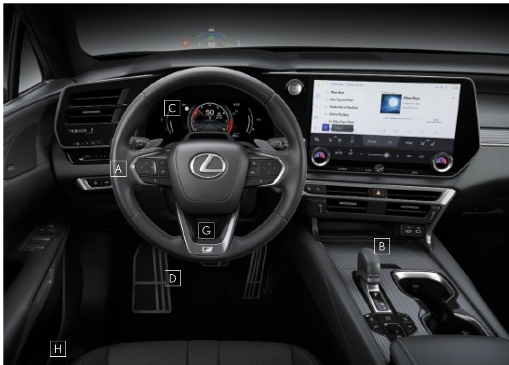
Trang bị trên F SPORT PERFORMANCE/F SPORT A_Vô lăng bọc da đúc lỗ với lẫy chuyển số/ B_Cần số bọc da đúc lỗ/ C_Màn hình tốc độ TFT/ D_Ban đạp và bệ nghỉ chân thể thao bằng nhôm/ E_Chi tiết trang trí bằng nhôm/ F_Ghế thể thao bọc da
