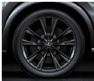
E_Lốp 235/50R21 101W & mâm hợp kim nhôm 21x8J (sơn đen bóng Black Metallic)
